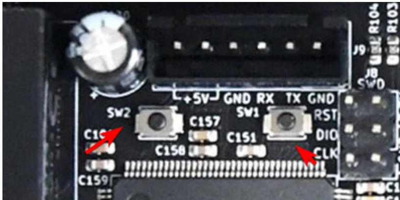
Wenn das Board schon über 24V angeschlossen ist geht auch folgendes **Boot Taste** (SW2) gedrückt halten, **Reset Taste** (SW1) einmal drücken und loslassen, dann die **Boot Taste** (SW2) loslassen.
